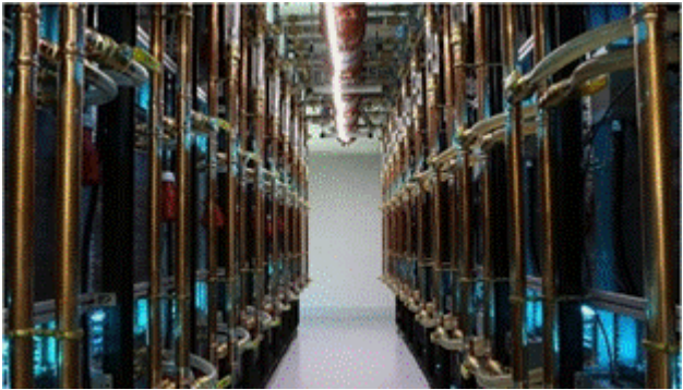
图 6：位于香港的大规模矿场、定制的 ASIC 芯片被垂直摆放以用来集成挖矿
