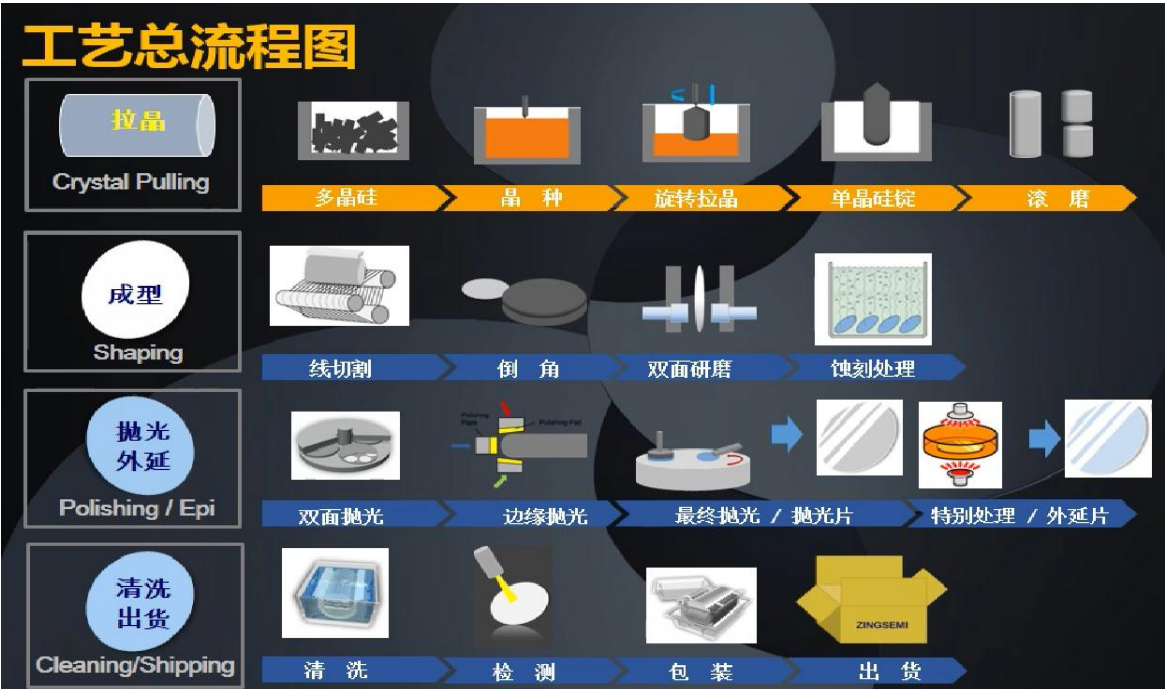
集成电路硅片生产的主要工序
