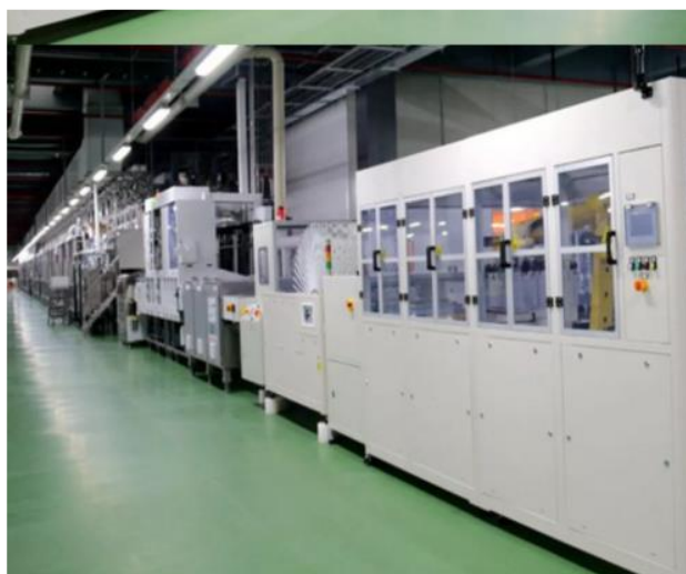
图 3. 景旺江西二期电镀线实现自动化
