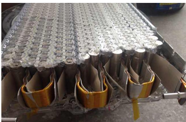
图15：特斯拉Model S 85拆解后的电池部分
