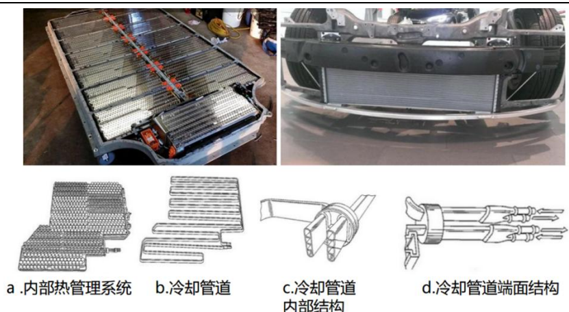
图19: 相变冷却系统包裹电池示意图
