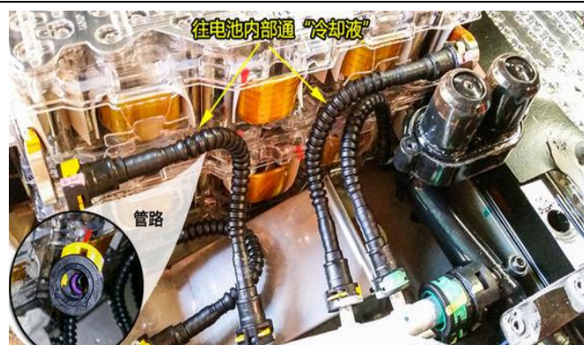
图2：冷却液通过电池组并通过铝管流动
