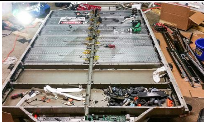
图 1：特斯拉电池板内冷却液管道示意图
